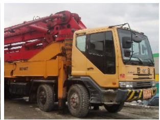
콘크리트 펌프 트럭
